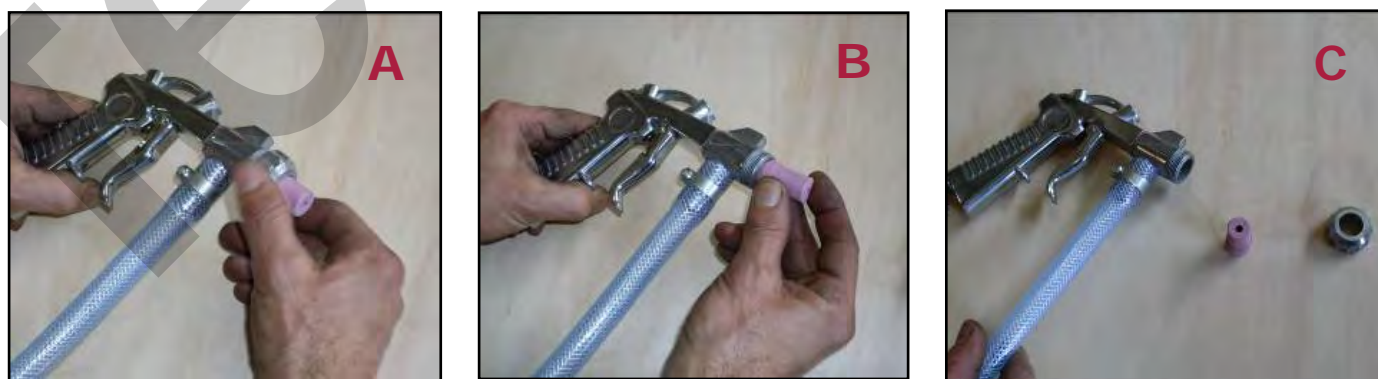
Figura 12 - Smontaggio dell'ugello della pistola sabbiatrice.
