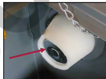
Figura 9 - Attacco al sistema di aspirazione
