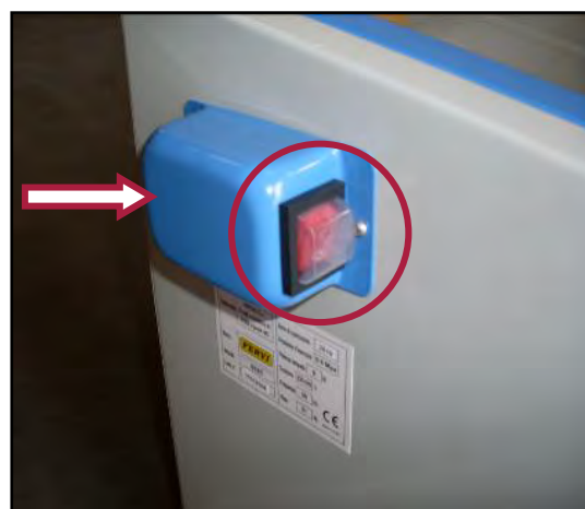
Figura 5 - Dettaglio interruttore e presa per spinotto.
